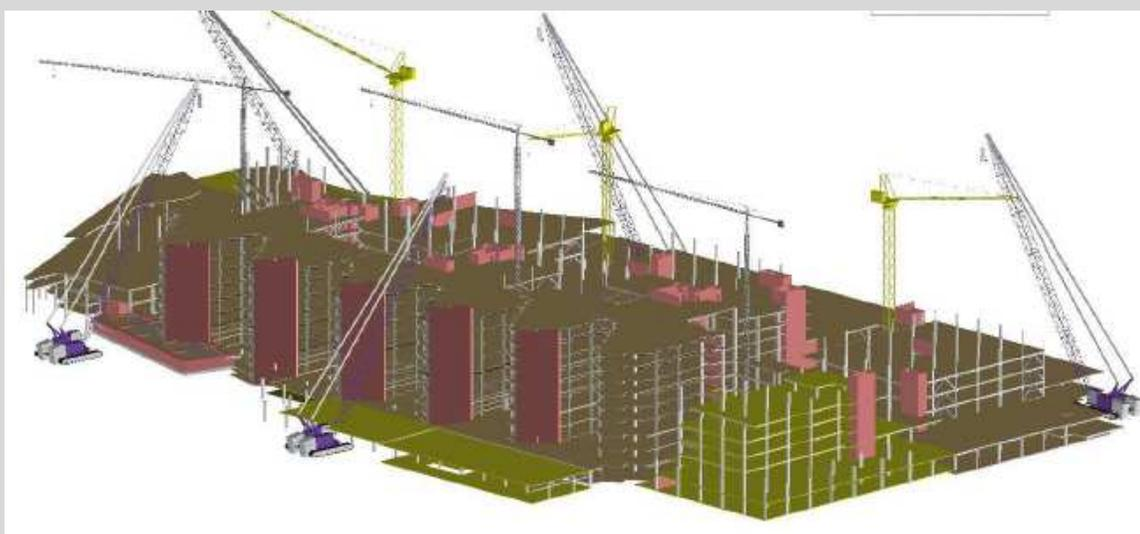
Sbancamenti, piste, gru, baracche, ponteggi, aree di stoccaggio, cassature, ecc. Interferenze gru, sotto servizi. Percorsi critici ai fini della **SICUREZZA**.
